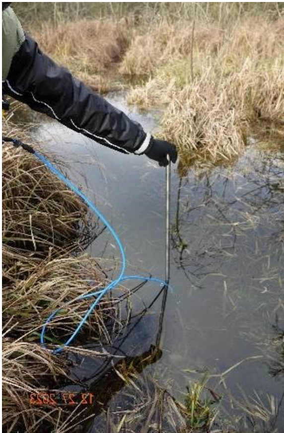
Ryc. 34. Pomiar przepływu wody na dopływie do rozlewiska (Pomiar 2, pkt GPS 118) Pomierzone prędkości na dopływie: 0,008; 0,007; 0,007 m/s
