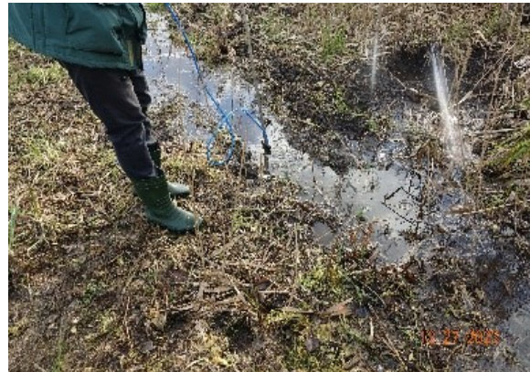
Ryc. 37. Pomiar prędkości przepływu wody na łące pomiary ( v \approx 0,054 m/s)
