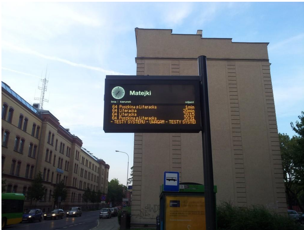
Rysunek 32 Tablica Informacji Pasażerskiej w ciągu ulicy Grunwaldzkiej przy Matejki wyświetlająca rzeczywiste czasy przyjazdu autobusów 265
