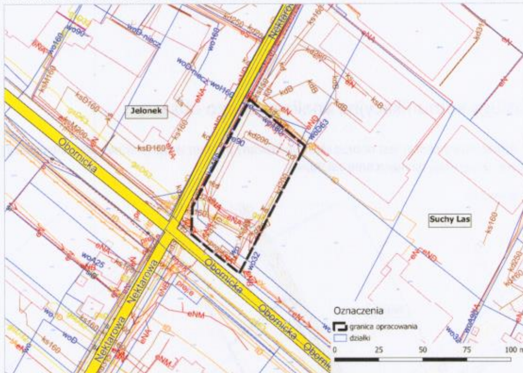
Ryc. 8 Sieć infrastruktury technicznej na analizowanym obszarze
